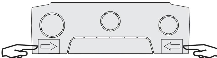
Fig. 44 – Encastre de la tapa de protección
