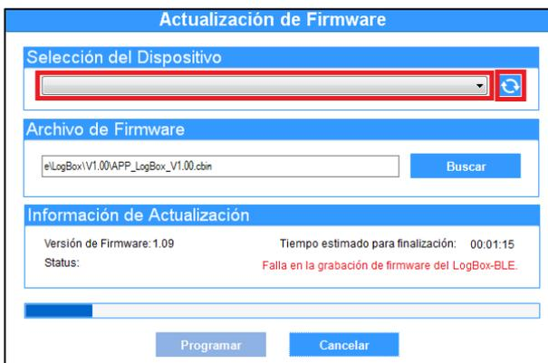
Fig. 56 – Falla en la grabación de firmware
