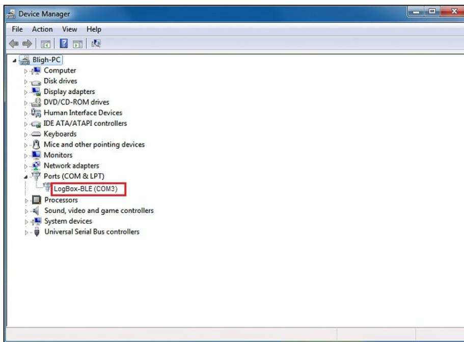
Fig. 51 – Configuración del puerto COM del dispositivo
