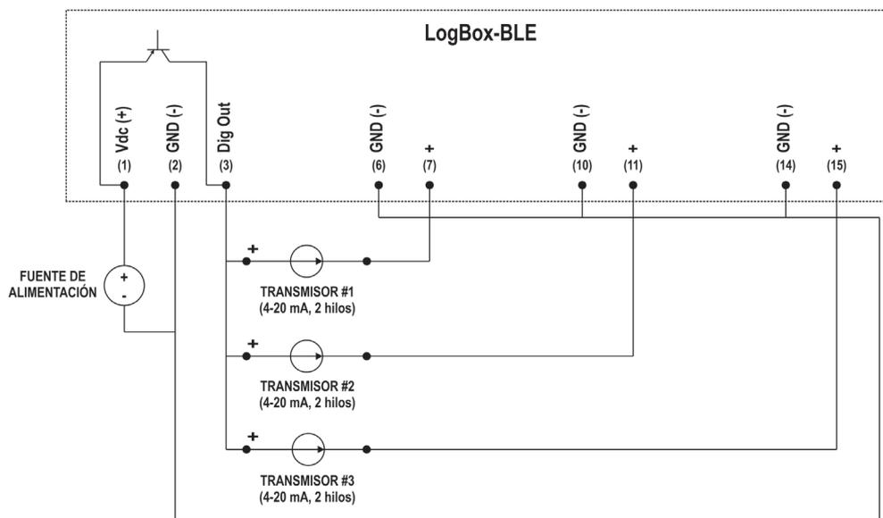
Fig. 48 - Conexión en modo llave electrónica auxiliar
