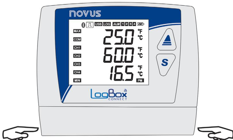
Fig. 43 – Desencaje de la tapa de protección
