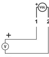
La conexión para la Alimentación se realiza en los terminales de acuerdo con la figura de al lado. La fuente utilizada debe ser de tipo corriente continua, con tensión entre 10 y 30 V y proveer una corriente mínima de 15 mA cuando no hay carga conectada en la salida digital. Si se conecta carga en la salida digital, la fuente utilizada debe ser capaz de suministrar corriente compatible con la carga utilizada.
